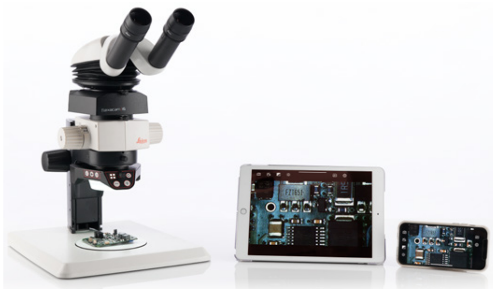
Fotocamera Flexacam i5 con stereomicroscopio M50 che utilizza l'app Enersight Mobile.
